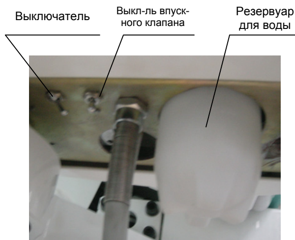
Рис. 9. Система подачи очищенной воды
