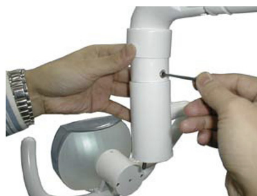
Рис. 15. Установка операционного осветителя
