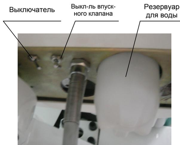
Рис. 9. Система подачи очищенной воды
