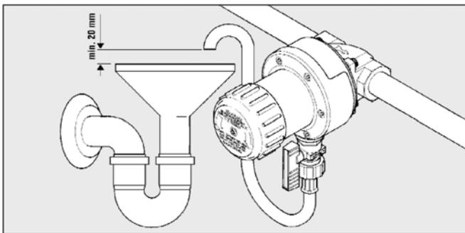
Необходимо регулярно обслуживать обязательный защитный фильтр (114) на входной водопроводной трубе. Пожалуйста, придерживайтесь инструкций его изготовителя.
