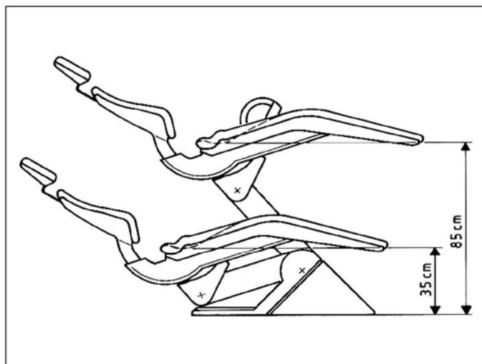
Дифференцированное перемещение с изменением угла наклона спинки относительно угла наклона сидения механически сопряжено.
