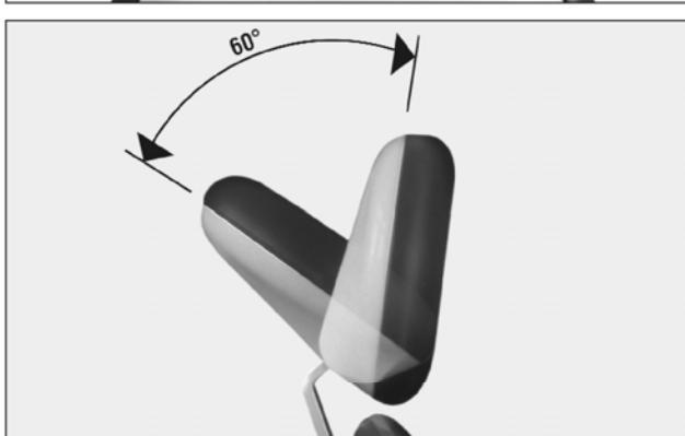
Для наклона назад, необходимо ослабить стопорное устройство (50), потянув его к себе. Наклон вперёд может быть выполнен без ослабления стопорного устройства. Подголовник можно без проблем снять с кресла и вставить обратно.
