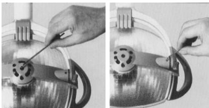
Потребуются чёрная поверхность и небольшой кусок мела. Нарисуйте на поверхности прямоугольник 10 x 20 см. Поместите отражатель Starlite вертикально на расстоянии 80 см над этим прямоугольником и установите самую слабую интенсивность света. Затемните помещение. Отрегулируйте поле освещения по прямоугольнику, поворачивая винт (13) вправо или влево торцевым ключом (размер 3, в аксессуарах). Переход между светом и темнотой должен находиться в пределах прямоугольника.
