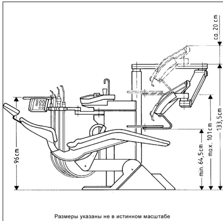
Поворотная консоль модуля ассистента имеет два плеча и чрезвычайно широкий рабочий радиус. Держатель инструментов и панель управления со столиком для лотка могут быть либо установлены очень близко к пациенту, либо отведены от пациента так, чтобы обеспечить рабочее пространство для ассистента.
