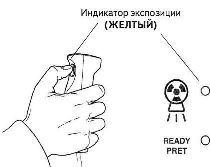
Нажмите и удерживайте кнопку включения экспозиции в течение всей экспозиционного цикла. Поворотный кронштейн будет вращаться в разных направлениях три (или четыре) раза. Во время съемки загорятся индикаторы на кнопке дистанционного включения экспозиции и на панели управления, кроме того, съемка будет сопровождаться звуковым сигналом.
