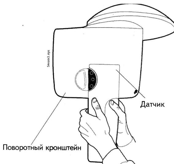
Закрепите датчик на поворотном кронштейне.
