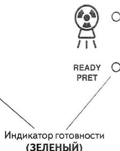
На панели управления и кнопке дистанционного включения экспозиции загорятся зеленые индикаторы. Кроме того, на дисплее панели управления появится слово READY. На экране компьютера появится надпись Waiting for Ready.
