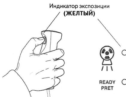
Нажмите и удерживайте кнопку включения экспозиции в течение всей съемки. Поворотный кронштейн выполнит один полный цикл съемки и вернется в исходное положение. Височные фиксаторы будут заблокированы. Во время съемки загорятся индикаторы на кнопке дистанционного включения экспозиции и на панели управления, кроме того, съемка будет сопровождаться звуковым сигналом.
