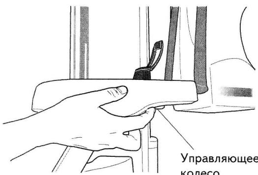
Для включения лазерной системы позиционирования пациента покрутите специальное колесо, находящееся на внутренней стороне позиционного стола. Обратите внимание на то, что через две минуты лучи автоматически отключатся. Если вы не успели закончить позиционирование пациента, включите лучи еще раз как это описано выше.
