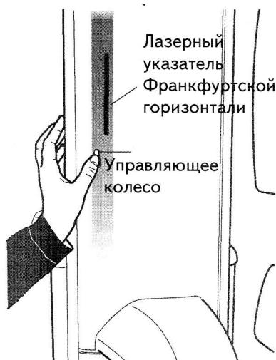
Лазерный луч, корректирующий положение Франкфуртской горизонтали, расположенный на боковой стороне телескопической колонны, может перемещаться вверх-вниз с помощью специального колесика, расположенного под прорезью.
