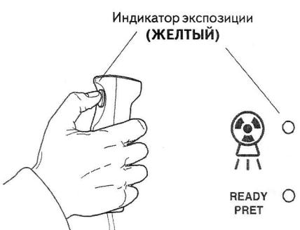
Нажмите и удерживайте кнопку включения экспозиции в течение всей съемки. Во время съемки загорятся индикаторы на кнопке дистанционного включения экспозиции и на панели управления, кроме того, съемка будет сопровождаться звуковым сигналом. По завершении цикла съемки височные фиксаторы открываются автоматически. После этого пациент может отойти от рентгеновского аппарата.
