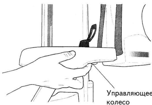
Для включения лазерной системы позиционирования пациента покрутите специальное колесо, находящееся на внутренней стороне позиционного стола. Обратите внимание на то, что через две минуты лучи автоматически отключатся. Если вы не успели закончить позиционирование пациента, включите лучи еще раз как это описано выше.
