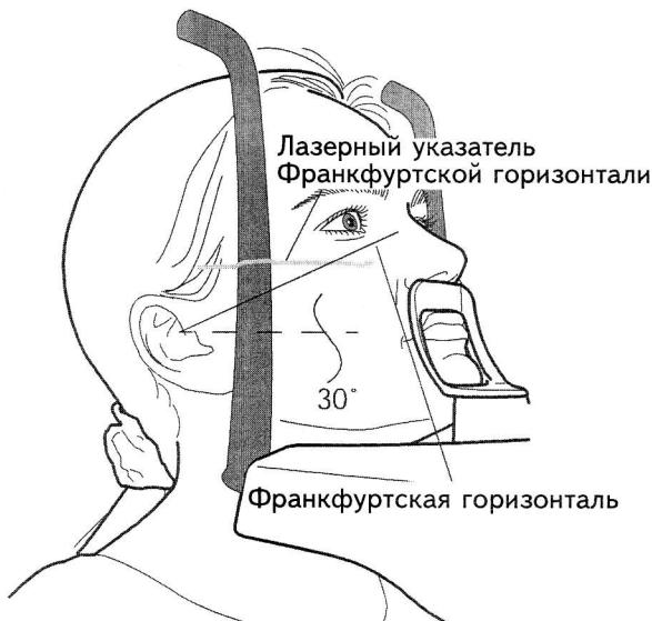
Откорректируйте положение головы пациента таким образом, чтобы Франкфуртская горизонталь оказалась поднятой до 30°: придерживая пациента за затылок и ориентируясь на положение лазерного луча, корректирующего положение Франкфуртской горизонтали, отрегулируйте угол наклона головы, поднимая и опуская позиционный стол с помощью специальных кнопок. Спина пациента должна быть выпрямлена. Немного поднимите установку вверх, заставив пациента слегка вытянуть шею.
