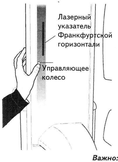
Лазерный луч, корректирующий положение Франкфуртской горизонтали, расположенный на боковой стороне телескопической колонны, может перемещаться вверх-вниз с помощью специального колесика, расположенного под прорезью.
