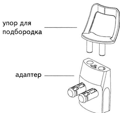
Для облегчения позиционирования пациента используйте упор для подбородка. Вставьте специальный адаптер в отверстия позиционного стола, затем вставьте упор в адаптер.
