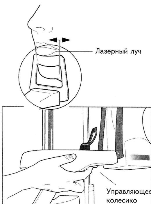
Для перемещения лазерного луча, обозначающего центр фокусного слоя, начните вращать колесо, находящееся под позиционным столом. Установите луч между вторым резцом и клыком. В подавляющем большинстве случаев этого будет достаточно, чтобы апикальная часть центральных резцов верхней челюсти оказалась в пределах фокусного слоя.
