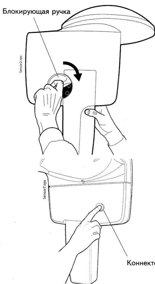
Повернув ручку на 180 градусов, вы зафиксируете датчик.
